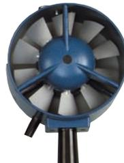
Auf dem Schutzring der beiden Flügelradanemometer (14143) und (14433) gibt ein Pfeil die Richtung an, in der der Wind das Anemometer durchströmen soll.
